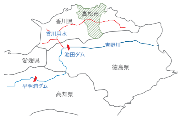
高知県の早明浦ダムから供給される香川用水
