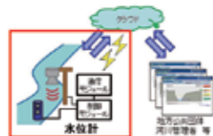
中小河川への水位計の普及促進のために水管理・国土保全局において開発した低コストな水位計のイメージ
