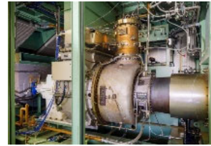
燃料アンモニアによるガスタービン 発電商用実証事業 (出典：IHI)
