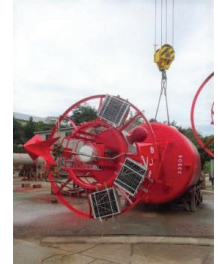
① 袖ヶ浦浮標基地 （コスト縮減の取組事例） 定期交換にあわせて 陸上にて監視装置を設置
