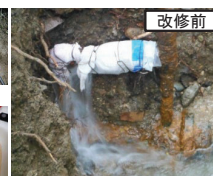
腐食により給水管が破損したり、給水管内部の発錆により赤水が発生
