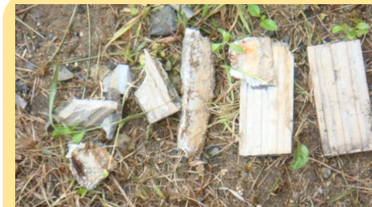
老朽化によりタイルが剥落
