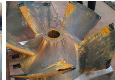
排水機場(羽根車の劣化)
