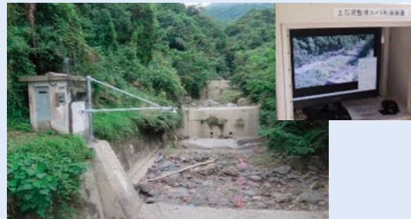
左: 監視カメラと土石流センサー 右: カメラ映像
