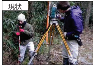
現状 現地に測量機器を設置し、土地の境界点の座標値を測量
