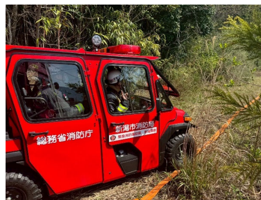
狭あいな林道を小型車両を活用し人員、資機材の搬送及び消防用ホースの延長などを実施
