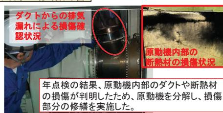
年点検の結果、原動機内部のダクトや断熱材の損傷が判明したため、原動機を分解し、損傷部分の修繕を実施した。
