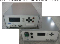
新型高感度地震観測装置 (上: AD装置、下: 電源装置)
