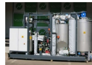
木質バイオマス利用 熱電併給装置
