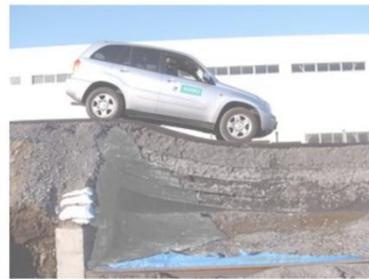
高強度のジオグリッドと拘束部材を用いた複合剛性層を路床に構築する工法
