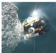
水中ロボットによるダム水中部の点検
