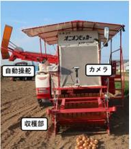
玉ねぎの自動収穫機 (試作機)
