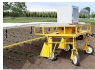
ばれいしょ自動検出プログラムを搭載したほ場管理車両
