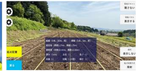
GNSS-RTKと連携することで誤差数cmの固定精度で圃場に平行直線ガイド表示することも可能。
