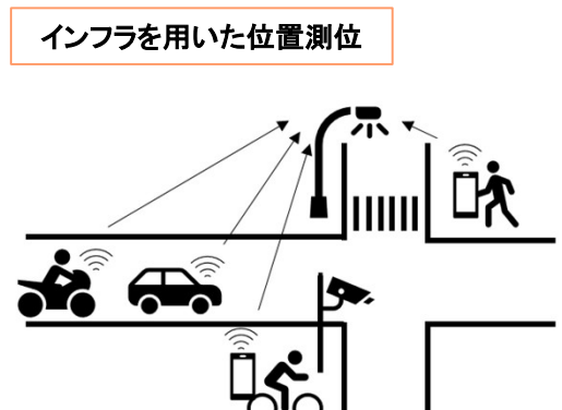
② 四輪、二輪等の検知・取得、統合処理、情報配信を行う支援システム・位置測位の検討イメージ
