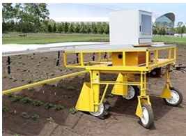
ばれいしよ自動検出プログラムを搭載したほ場管理車両
