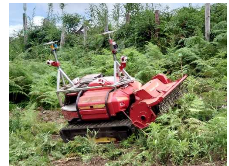
衛星測位を活用して走行する 自動運転下刈り機械
