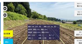
GNSS-RTKと連携することで誤差数cmの固定精度で圃場に平行直線ガイド表示することも可能。
