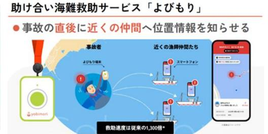
海難事故発生時に、首掛け式デバイスのボタンを5秒長押しすることで事故の発生位置を近くの船舶に発信し、事故者の探索時間を短縮。
