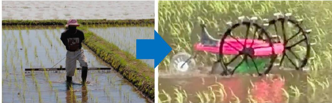
GPS搭載ロボットが水田を自動走行し、泥をかき混ぜ水を濁らせることで雑草の光合成を遮断し、除草の手間を削減。
