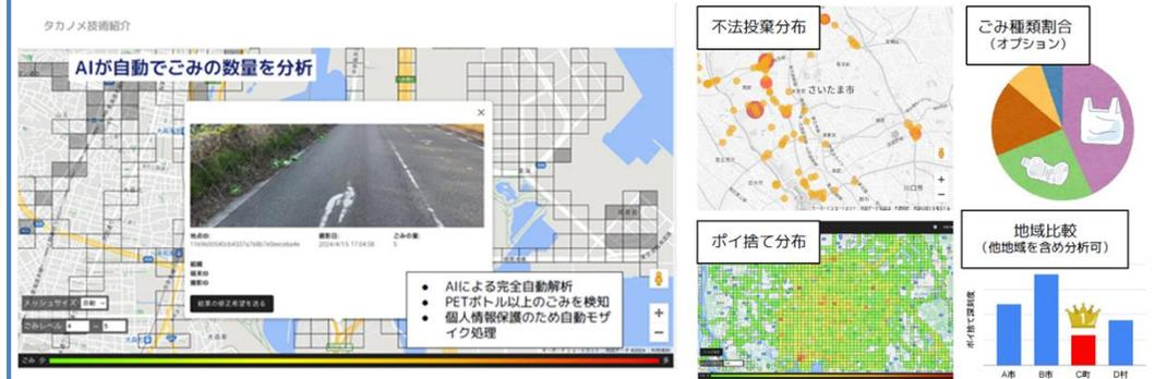
専用の車載カメラが路上のゴミを自動で検知し、その位置をデジタルマップに可視化することにより、路上清掃を効率化。
