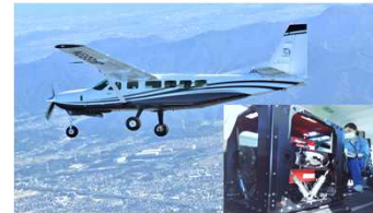
航空重力測量 (右下:航空重力計)
