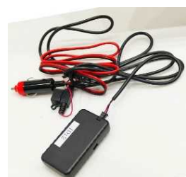
「みちびき」対応トラッカー ＜(株)フォルテ製＞ サイズ: 83×44×17.7mm 重量: 56.1g
