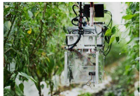
AGRIST(株) (宮崎県)が開発したピーマン収穫機
