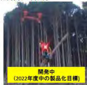
開発中 (2021年度中の製品化目標) リモコンにより油圧式集材機とグラブを操作
