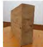
BP材(製材を接着した大断面の構造用材)
