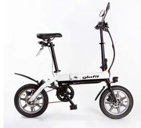
ハイブリッドバイクGFR-01 原付モード（電動駆動）と自転車モード （ペダル走行）を切り替えることができる パーソナルモビリティ
