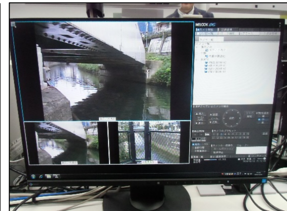
水位監視画面 (総合指令所)
