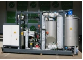
木質バイオマス利用熱電供給装置
