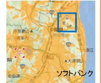
車載型基地局(左上)と令和元年東日本台風による被害最大時の携帯電話3社のエリア支障
