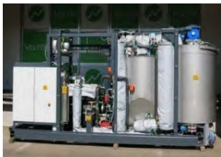
木質バイオマス利用熱電併給装置
