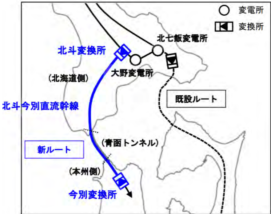
新北海道本州間連系設備概略系統図（北海道電力(株)ウェブページより）
