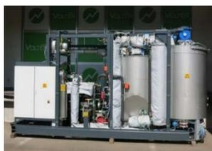
木質バイオマス利用熱電併給装置
