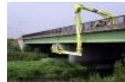
橋梁点検車を使った橋梁点検
