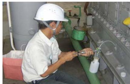
排水機場等機械設備の潤滑油分析による劣化診断
