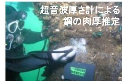
超音波厚さ計による鋼の肉厚推定
