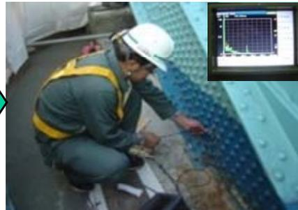
超音波による非破壊検査
