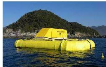
図 ジャイロ式波力発電装置
