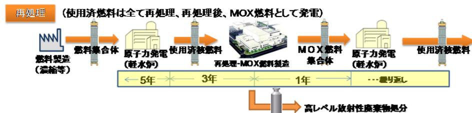
(図 1) 再処理モデルの概要
