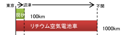
電気自動車の走行距離を100kmから1000km以上に
