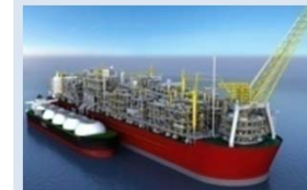
洋上LNGプラント
