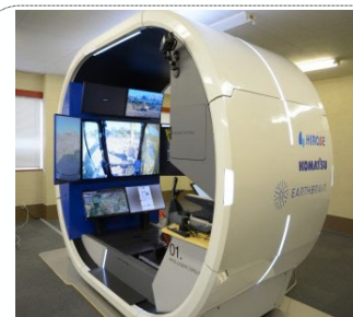
建設機械の遠隔施工 自動施工・遠隔施工
