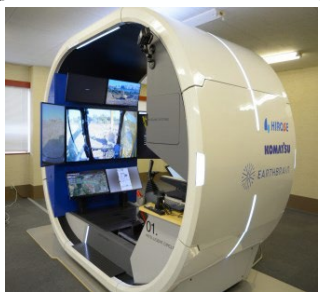
建設機械の遠隔施工
