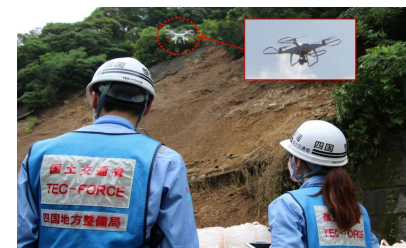
ドローンを用いた被災状況調査
