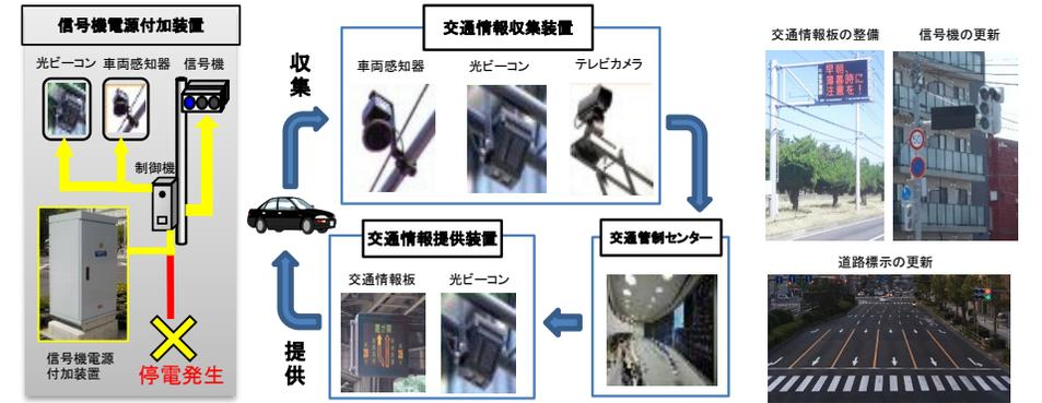
信号機電源付加装置を整備し、停電発生時に信号機等に電力を供給
