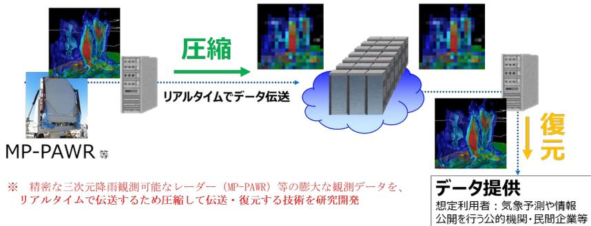
※ 精密な三次元降雨観測可能なレーダー (MP-PAWR) 等の膨大な観測データを、リアルタイムで伝送するため圧縮して伝送・復元する技術を研究開発
