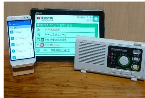
携帯電話網等を活用した情報伝達システムの個別端末の例
