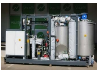
木質バイオマス利用 熱電供給装置
