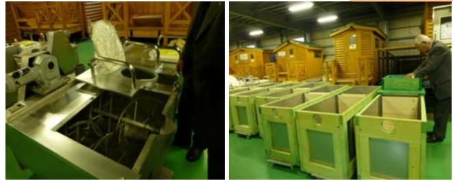
現地での実証試験で使用するバイオトイレ(左)及び新浄化システム(右)
