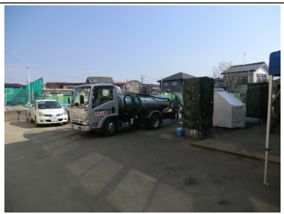
汲み取り作業中の様子（仙台市）*3
