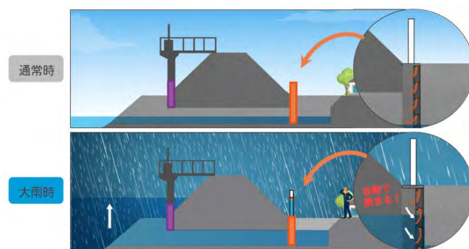
通常時・大雨時の無動力減災ゲートの動き
