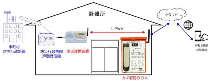
遠隔で「鍵収容 BOX」を操作する系統図
