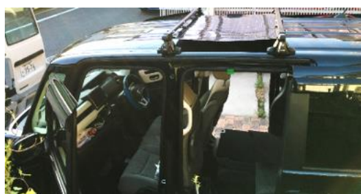
太陽光パネルを備えた防災給電カーの外観
