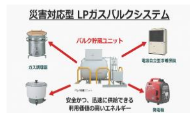
LP ガスを貯蔵、供給するシステム
