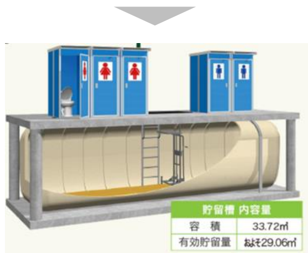
災害時のトイレ設備としての利用
