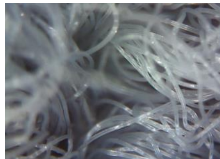
施工前後のタイルカーペットの拡大画像（225倍） 繊維の奥から汚れが落ちていることが確認できる
