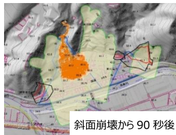
斜面崩壊後に土砂と雨水が混合し、土石流になり流下し、下流側が氾濫するまでのシミュレーション
