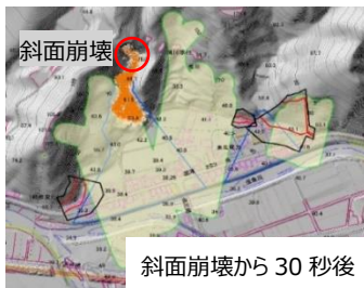
斜面崩壊後に土砂と雨水が混合し、土石流になり流下し、下流側が氾濫するまでのシミュレーション
