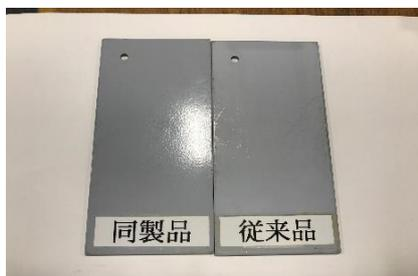
紫外線照射試験結果
